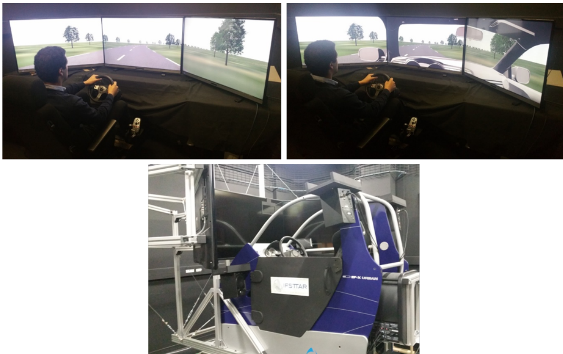
Figure 4. Illustration des trois simulateurs utilisés dans l'expérimentation. En haut : simulateur bas coût sans cabine (gauche) et avec cabine complète (droite). En bas : simulateur intermédiaire avec cabine partielle.
