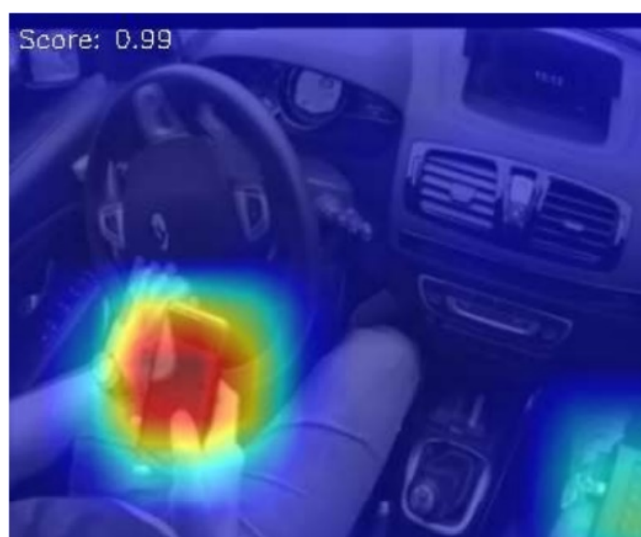
Figure 9 : Exemple de CAM permettant la détection d'une utilisation « À la main »
