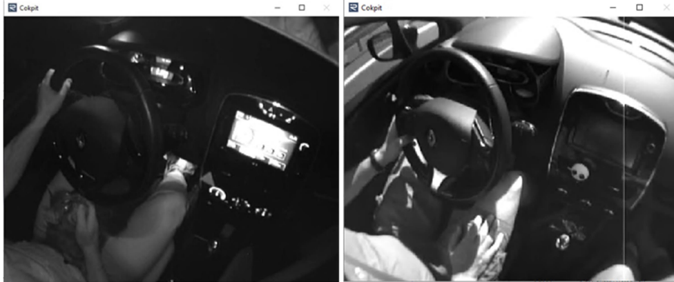
Figure 13 : Exemples de fausses détections dues à la manipulation d'un objet et à l'ombre du volant
