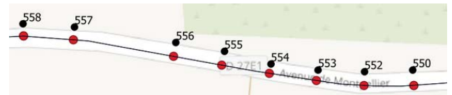
Figure 6 : Rétroprojection des points GPS de la trace (en noir) sur le chemin proposé par l'algorithme de map-matching (en rouge)
