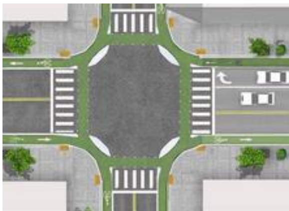
Figure 39. Coloration de la totalité de la voie cyclable (voie de circulation isolée + intersection).
