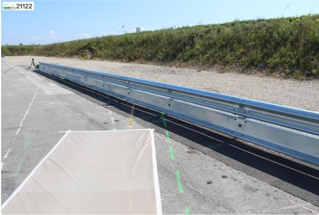
Figure 31 Barrière équipée d'écrans motards
