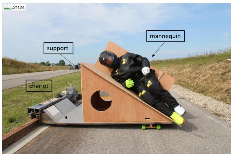
Figure 4 Configuration d'essai chute motard avec ses dispositifs
