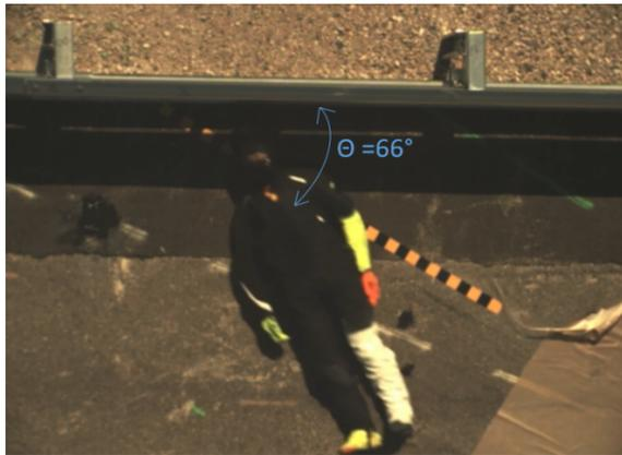
Figure 33 Essai d'impact du motard tête, 60°
