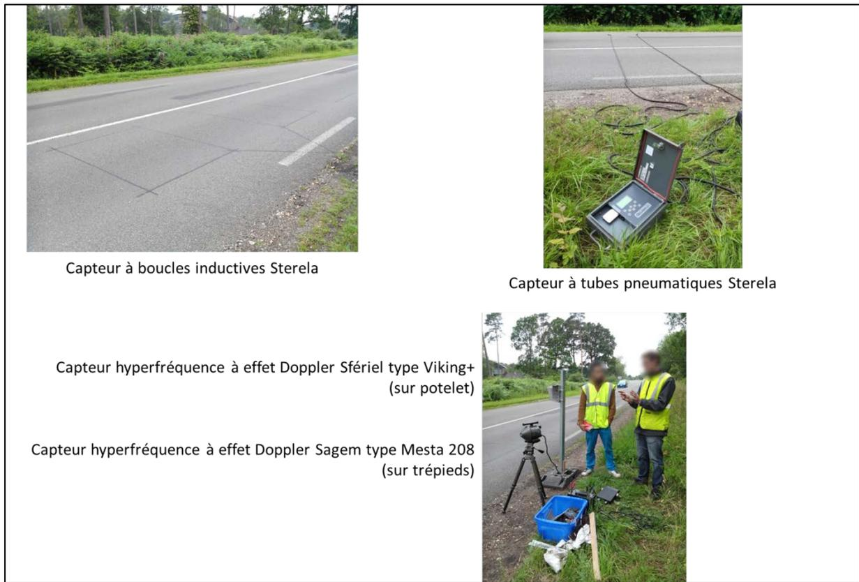
**Figure 32 : comparaison de différents capteurs de mesure de vitesses
