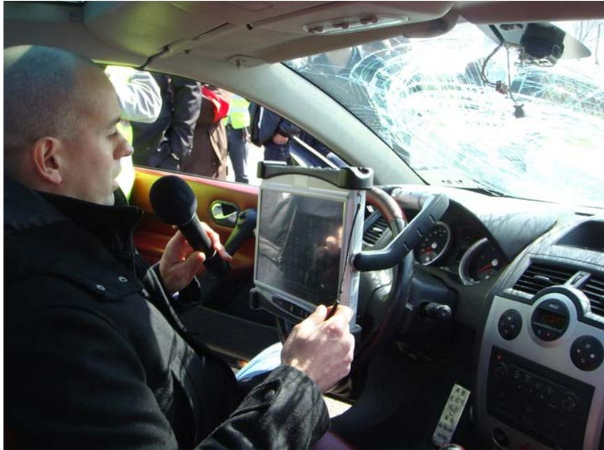
**Figure 37 : Stage de formation organisé par la société AAE Innovation, connexion d'un ordinateur sur la prise diagnostic (OBD) pour la lecture des calculateurs après crash test**
