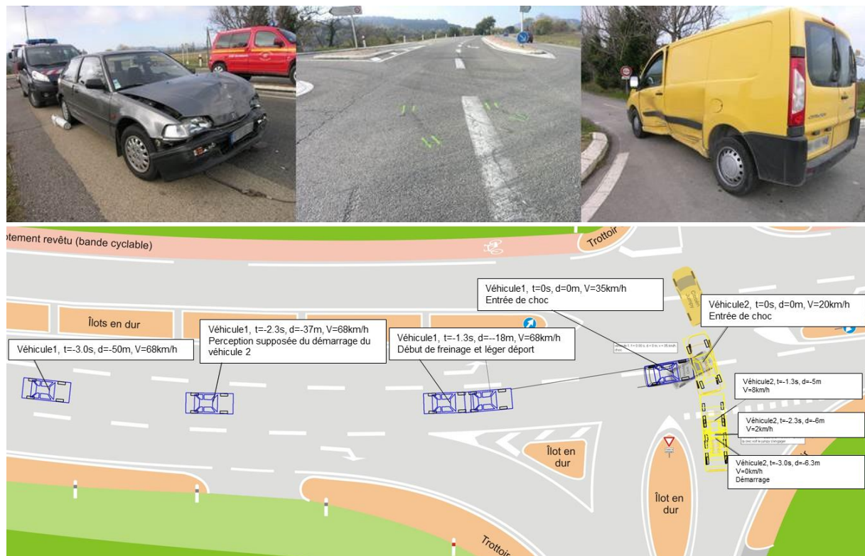
Figure 1. Photos et résultats de la reconstruction cinématique d'un accident, description spatio-temporelle de son déroulement (schéma et photos EDA-IFSTTAR)
