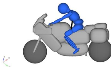
Figure 7 : Cas d'accident n°2, modélisation multicorps de l'accident
