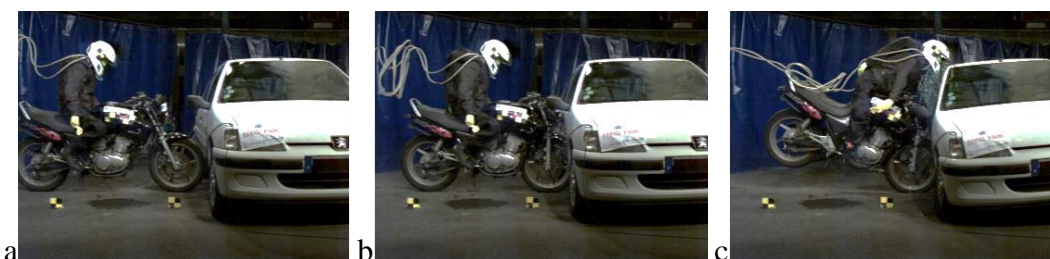
Figure 22 : Chronologie du crash-test réalisé avec l'airbag radio « Bering » a) Impact moto/obstacle b) airbag gonflé c) impact motocycliste/obstacle
