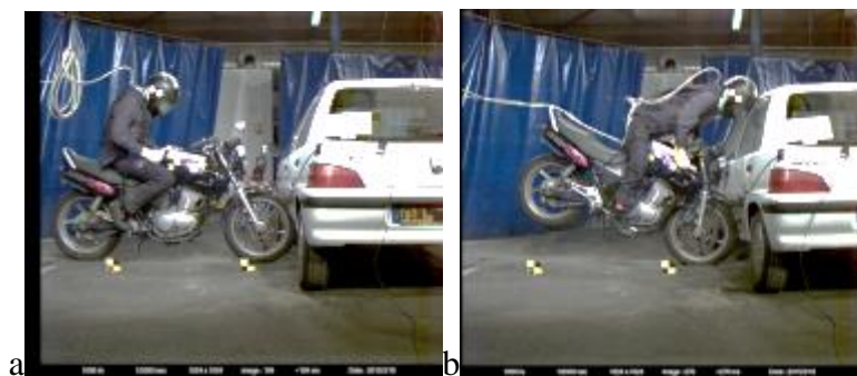
Figure 18 : Chronologie du crash-test réalisé avec l'airbag filaire « Helite » a) Impact moto/obstacle b) déclenchement airbag et impact motocycliste/obstacle
