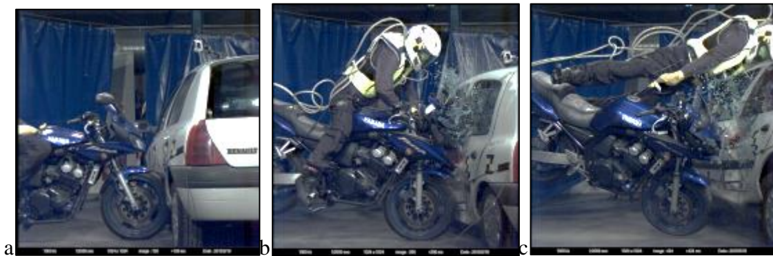
Figure 17 : Chronologie du crash-test réalisé avec l'airbag filaire « Allshot » a) Impact moto/obstacle b) déclenchement airbag c) impact motocycliste/obstacle
