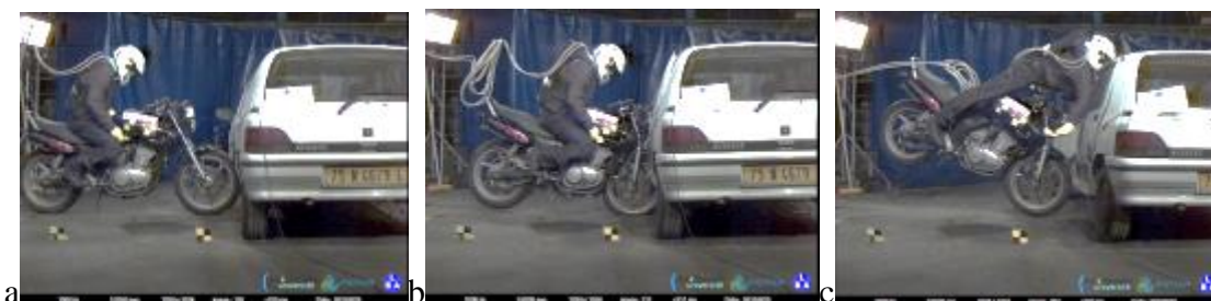
Figure 21 : Chronologie du crash-test réalisé avec l'airbag radio « Dainese » a) Impact moto/obstacle b) airbag gonflé c) impact motocycliste/obstacle
