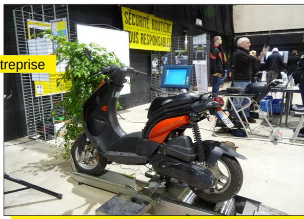
Contrôle au banc de puissance
