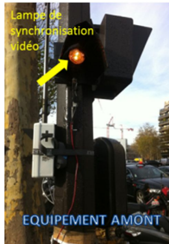
Illustration 4: La lampe de synchronisation vidéo
