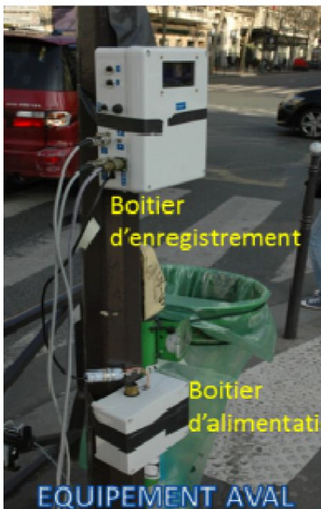
Illustration 5: Le dispositif d'enregistrement
